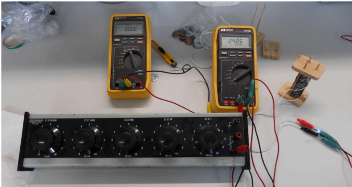
Figura 4-2. Montaje instrumental para medir la resistencia interna de la pila a columna: amperímetro, voltímetro, pila, banco de escala de resistencias. En esta foto se capta el detalle del voltaje al conectar un LED azul.
