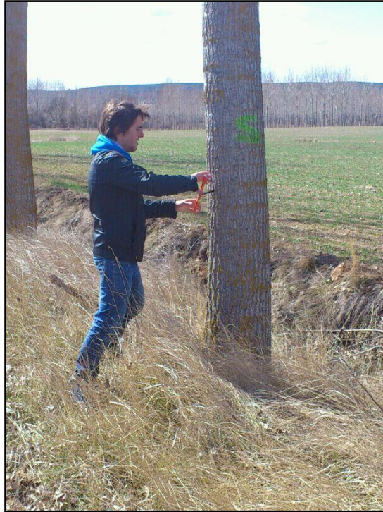
Muestreo de edad de chopo mediante barrena Pressler. Foto: Daniel Carrasco Gil.
