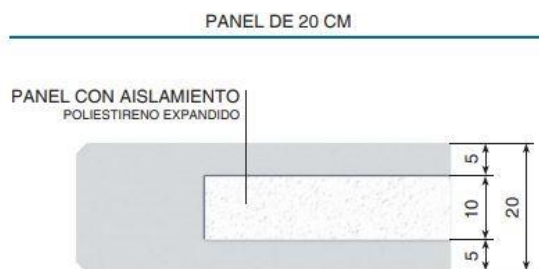
Figura 2.5.5-1 Sección cerramiento prefabricado de hormigón
