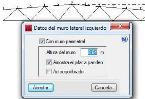
Figura 4.1.2-1 Cuadro características muro perimetral
