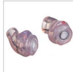
3. SOUNDSCOPE: Protectores a medida con un circuito activo que amplifica los sonidos ambientales suaves y limita los sonidos fuertes o ruidos de impacto. Fabricados en material acrílico. Diseñado con control de volumen para mejor ajuste.
