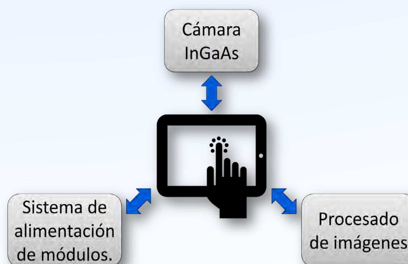
Fig. 5. Esquema del sistema de control del prototipo.
