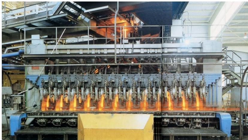
Figura 4: Máquina de sección independiente de doce secciones.
