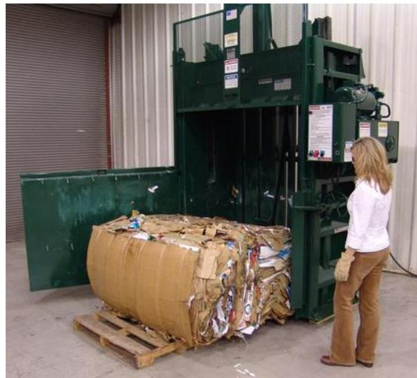
Figura 32: Prensa hidráulica vertical.
