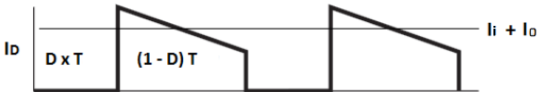
Ilustración 79 – Corriente por el diodo D en el convertidor Sepic.
