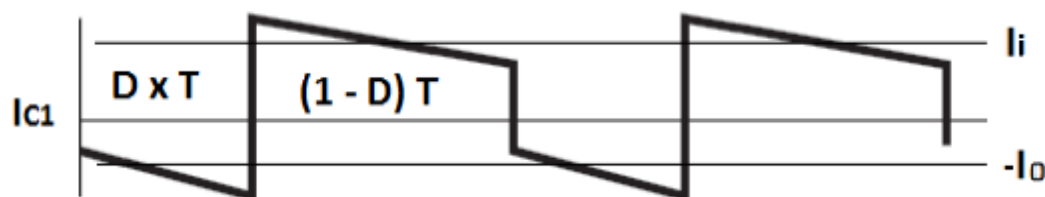
Ilustraci3n 81 – Corriente por el condensador C_1 en el convertidor Sepic.
