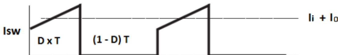
Ilustración 80 – Corriente por el polo de potencia en el convertidor Sepic.
