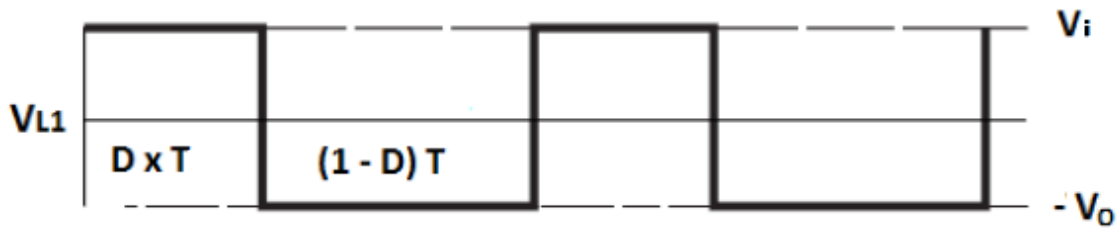
Ilustración 85 – Tensión en la inductancia L_1 del convertidor Sepic.
