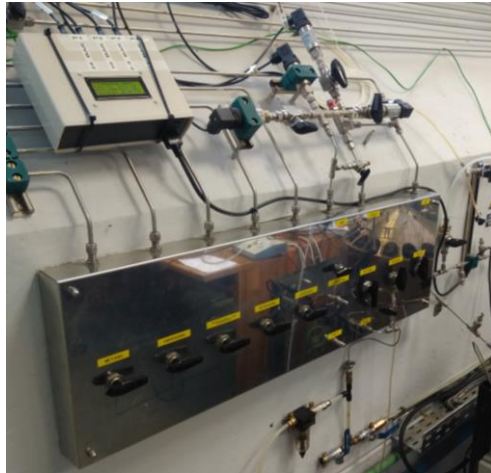
Fig 3.13. Sistema de sensores, válvulas y conductos para el llenado de la bomba.
