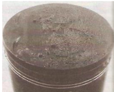
Fig 2.3. Efecto del picado sobre un pistón [11].
