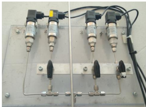
Fig 3.3. Transductores piezorresistivos y válvulas de cierre.
