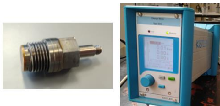
Fig 3.4. Transductor piezoeléctrico y amplificador Kistler.
