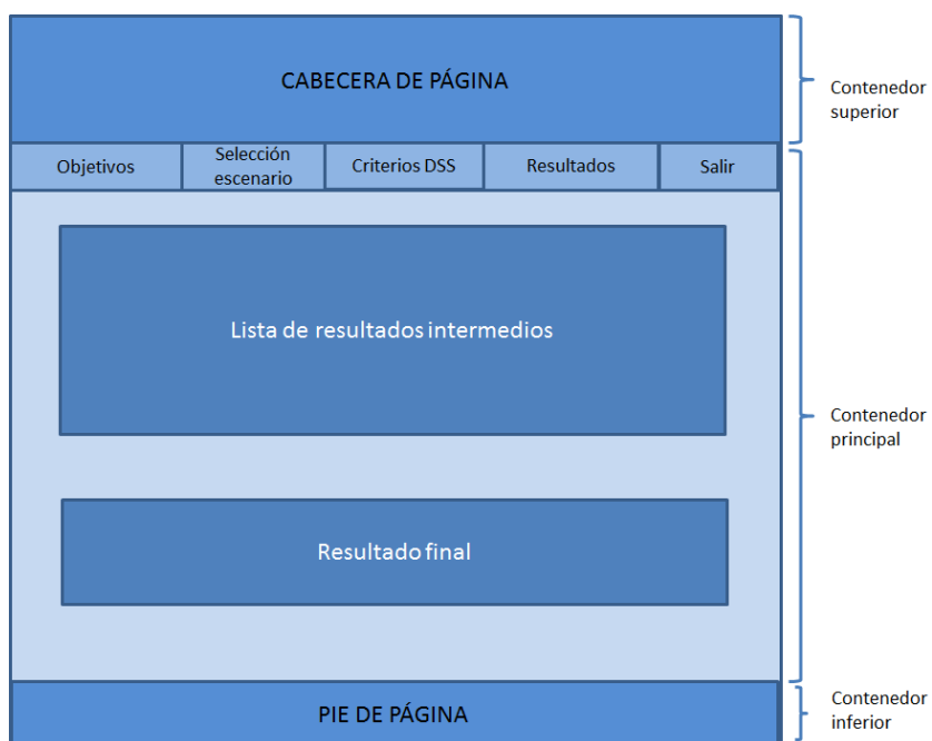
Figura 133: Diseño de la página para la consulta de información de los resultados de un escenario de la interfaz DSS
