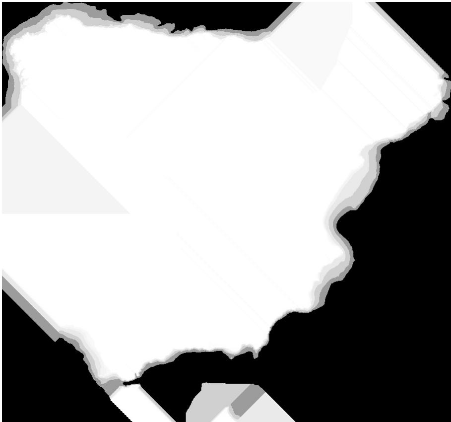
Figura 145: Resultado de la operación rellenar celdas sin datos por vecindad de Sextante a partir de la Batimetría
