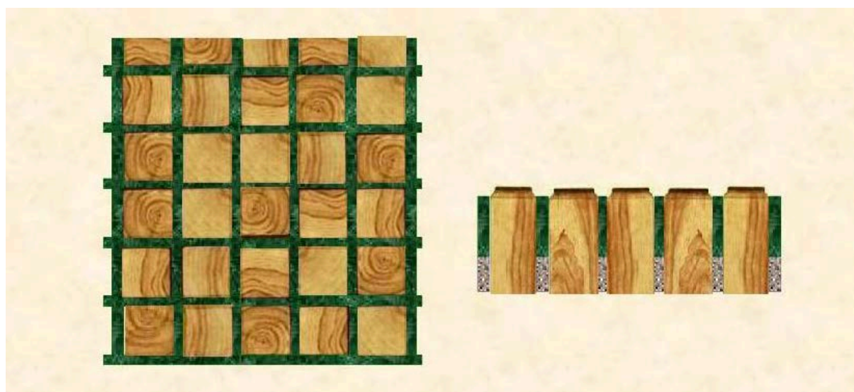
Fig. 7. Esquema de proyecto de formalización en damero de los adoquines de madera con la presencia del césped.
