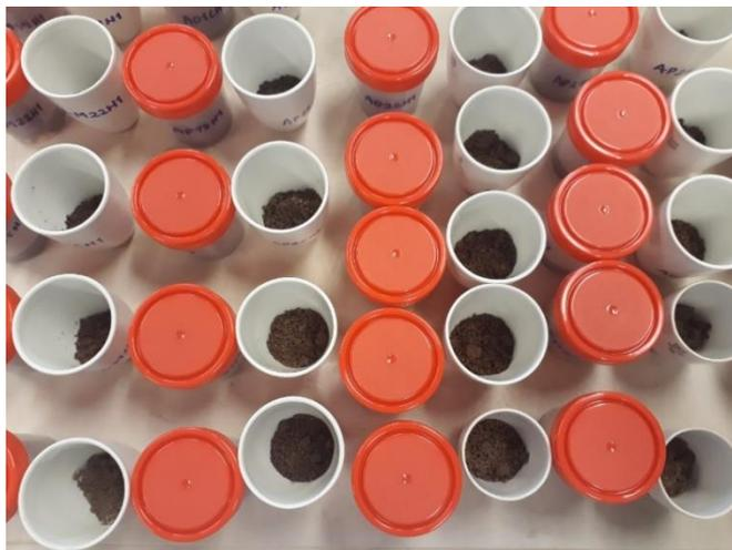
**Figura 11.** Muestras de suelo para determinación de C y N de la biomasa microbiana por el método de fumigación - extracción
