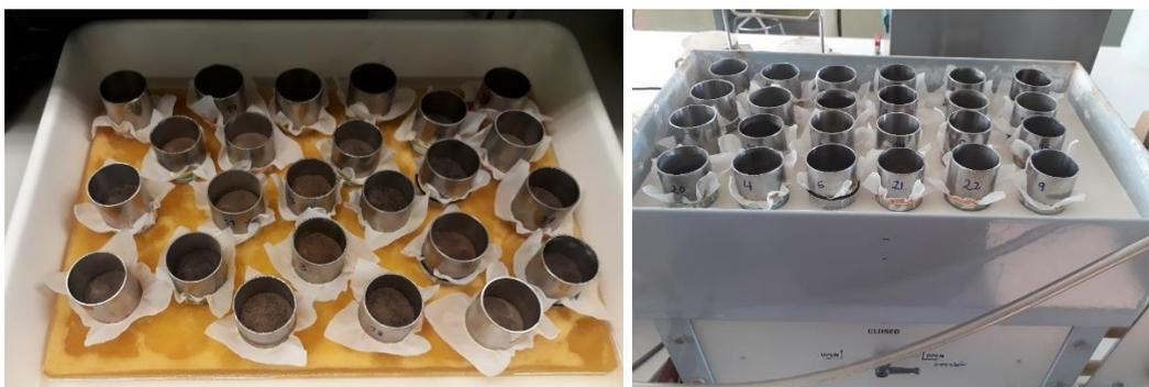
*Figuras 1 y 2. Pruebas de capacidad máxima de retención de humedad en suelos*
