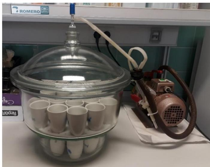
**Figura 12.** Desecador de vacío con muestras a fumigar
