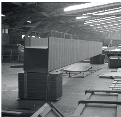
[33] Prototipo de la estructura principal de la viga cajón en U en la fábrica de Ralph Symonds realizada en madera con una longitud de unos 15 metros. Asgaard Andersen, M. (2014)
