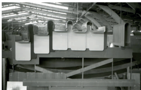
[24] Prototipos de las vigas cajón en la fábrica de Ralph Symonds. Rematadas con piezas de madera que cierran el alma hueca de la viga. Imágenes de Utzon Archives Bayview www.utzon-archives.aau.dk © Utzon Archives/Aalborg University & Utzon Center.
