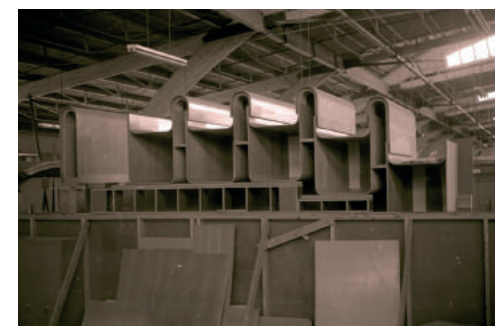
[42] Vigas de madera recubiertas con aluminio Imágenes de Utzon Archives. www.utzon-archives.aau.dk © Utzon Archives/Aalborg University & Utzon Center.
