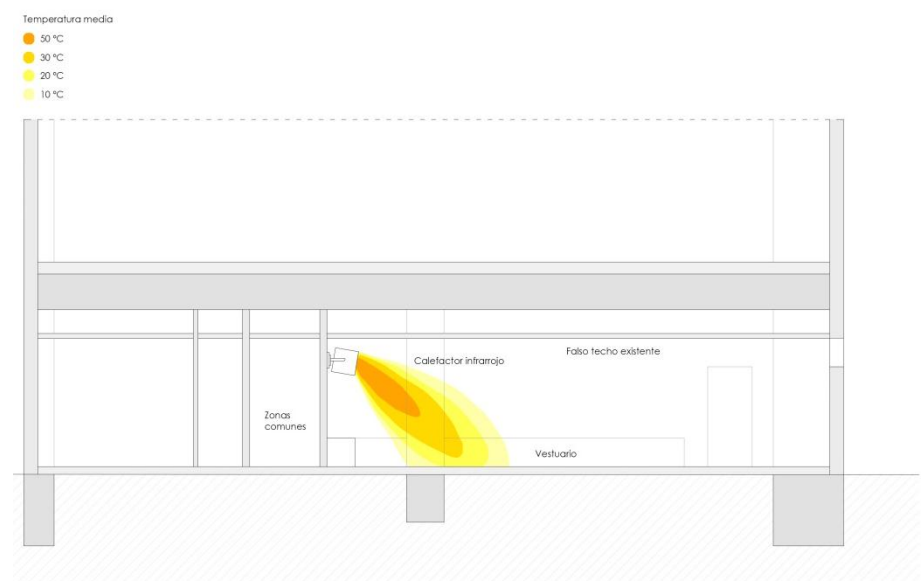
Imagen 52. Gráfica—sección— de la temperatura irradiada por los calefactores infrarrojos en cada vestuario (ver Plano L4)
