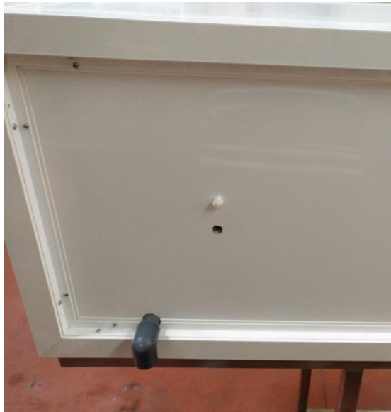
Figura 2.12: Conducto de desagüe situado en la parte posterior del equipo.
