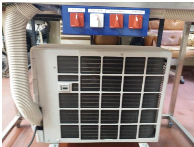
Figura 2.9: Bomba de calor
