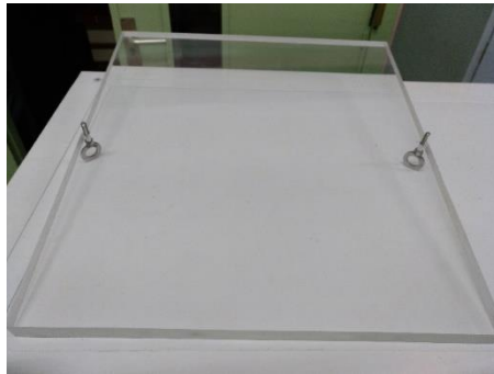
Figura 2.1: Panel de metacrilato que tapa uno de los accesos al interior de la instalación.
