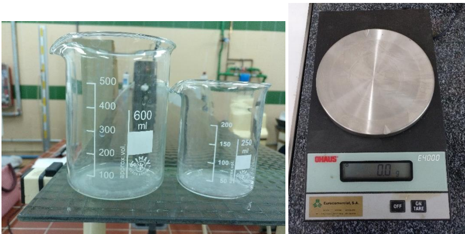
Figura 3.1.4: Instrumental utilizado para la graduación de la cubeta del humidificador.
