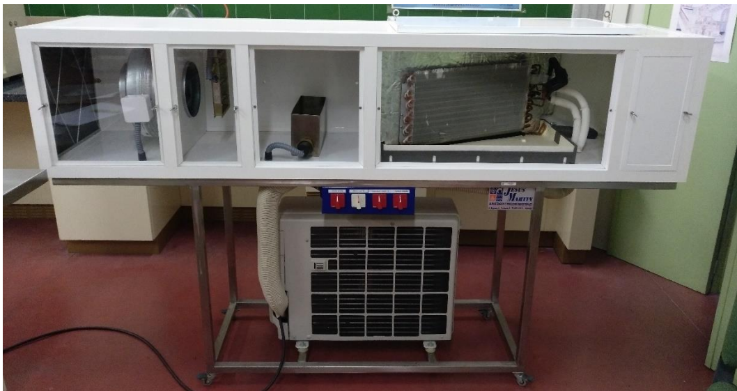
Figura 2.3: Vista frontal de la unidad de tratamiento de aire
