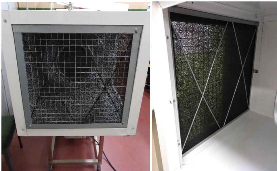
Figura 2.5: Vista del filtro de partículas desde el exterior e interior del equipo.
