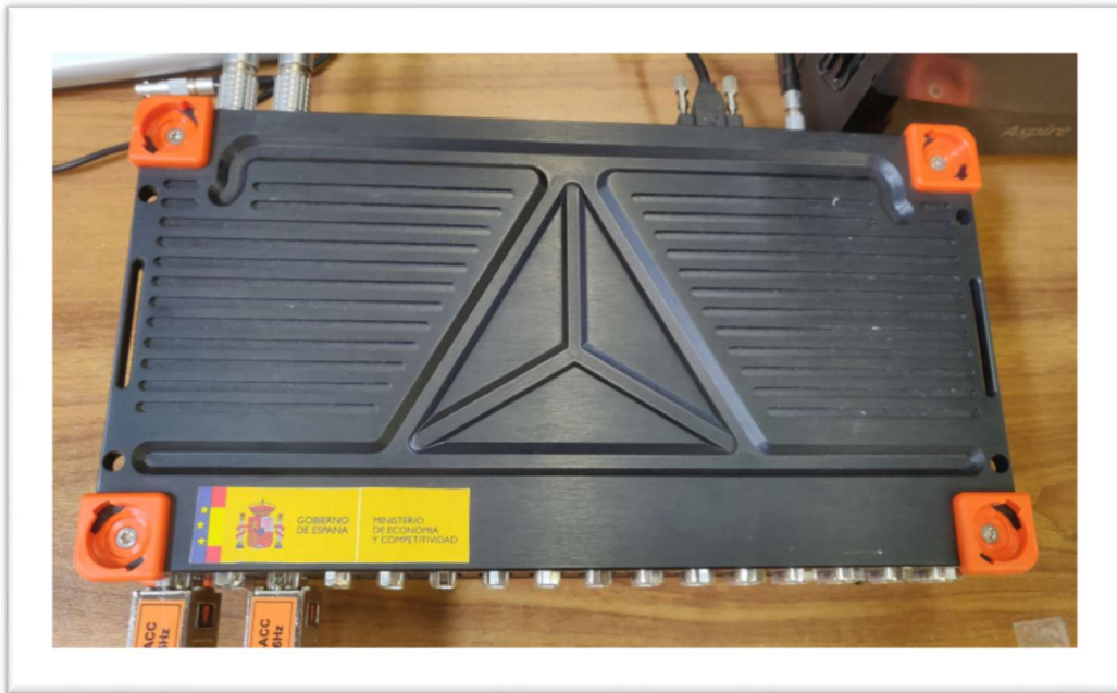
Figura 3.9.- Sistema de adquisición de datos Sirius HD-STG
