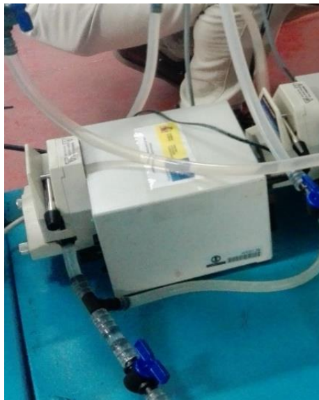
Figura 3.18. Bomba peristáltica en la instalación.
