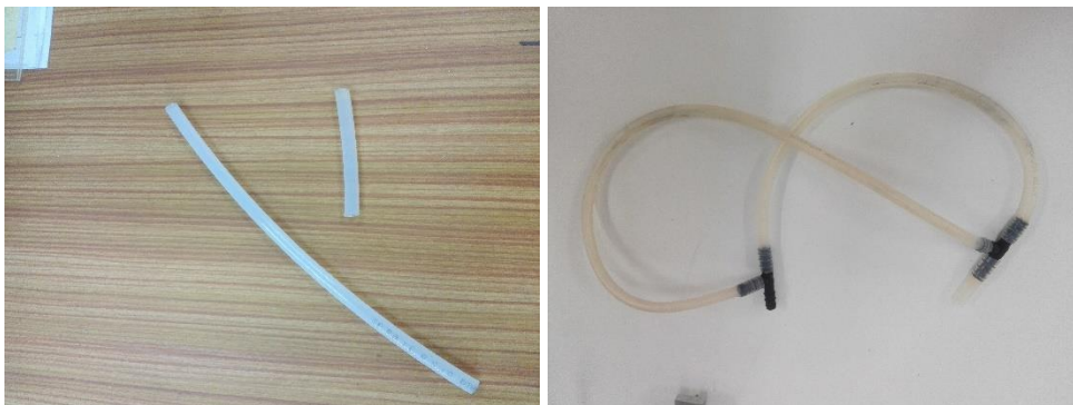
Figura Anexo 4.4. Tubos semirrígidos (izq.) y tubos Masterflex (der.)
