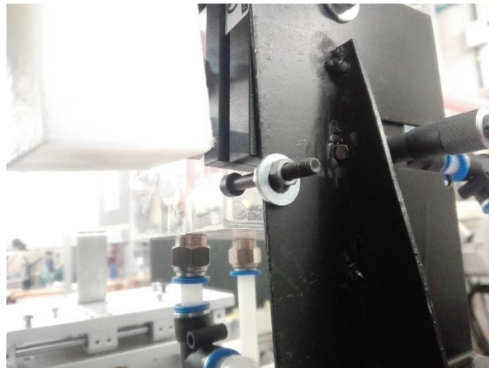
Figura Anexo 5.3. Tornillo que evita movimiento relativo entre placas.
