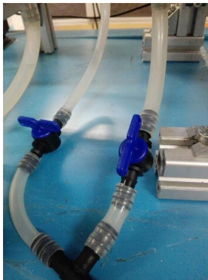
Figura Anexo 4.7. Llaves de paso cerrada (izq.) y abierta (der.)
