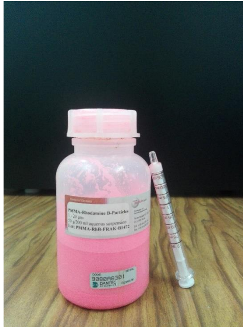
Figura 3.15. Envase de partículas trazadoras y jeringuilla para su inyección.
