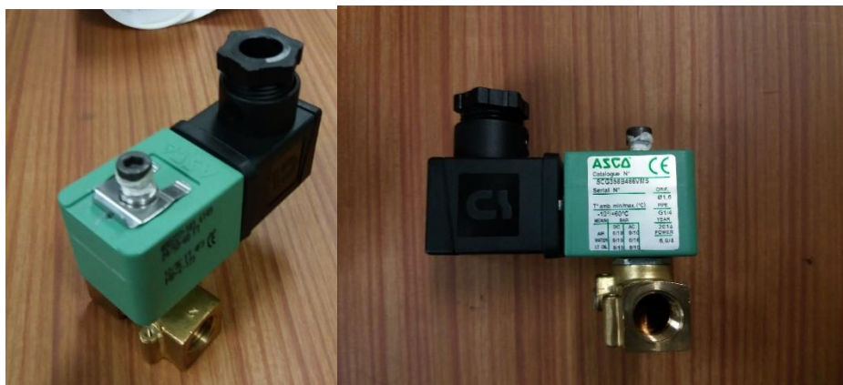
Figura 3.21. Electroválvula 3/2 convertida en 2/2.
