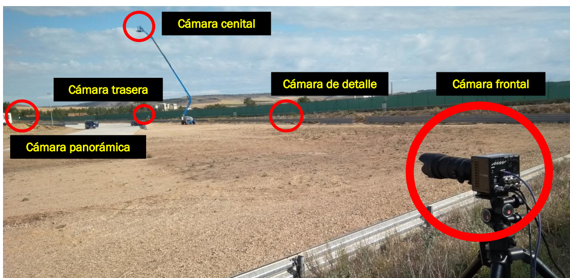
Fig. 66: Situación de las cámaras implicadas en la grabación del ensayo
