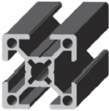
Fig. 36: Detalle sección perfil Fasten
