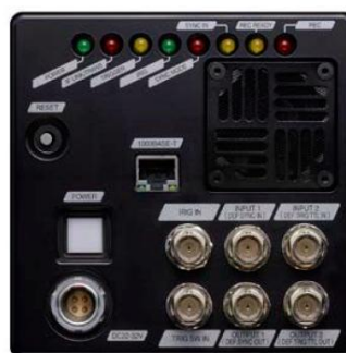
Fig. 23: Conexiones de la cámara
