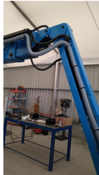
Fig. 49: Manguera conductora de cableado (gris claro).
