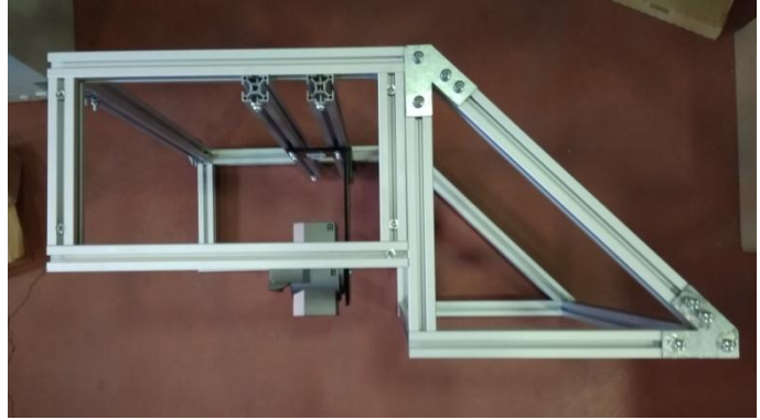
Fig. 57: Estructura completamente ensamblada
