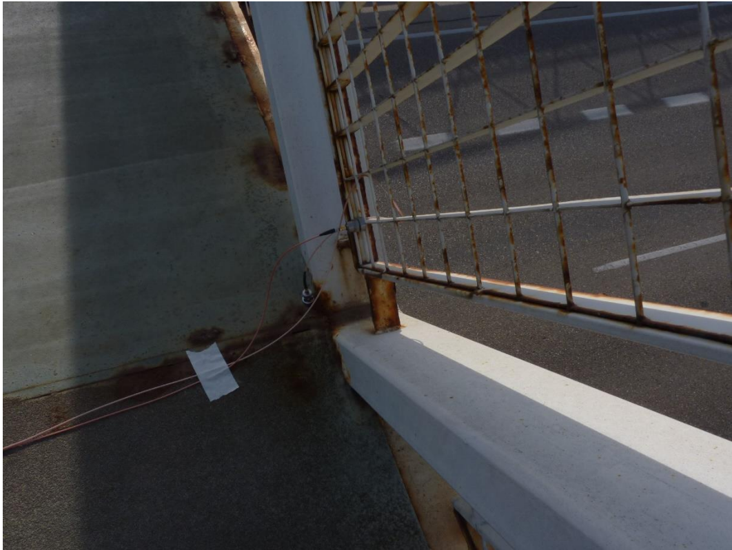
Ilustración 26- Acelerómetros vertical y horizontal con cable fijado al suelo
