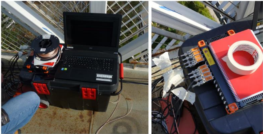
Ilustración 23- Identificación cables en la entrada del SIRIUS HD-STG y, ésta, conectada al ordenador
