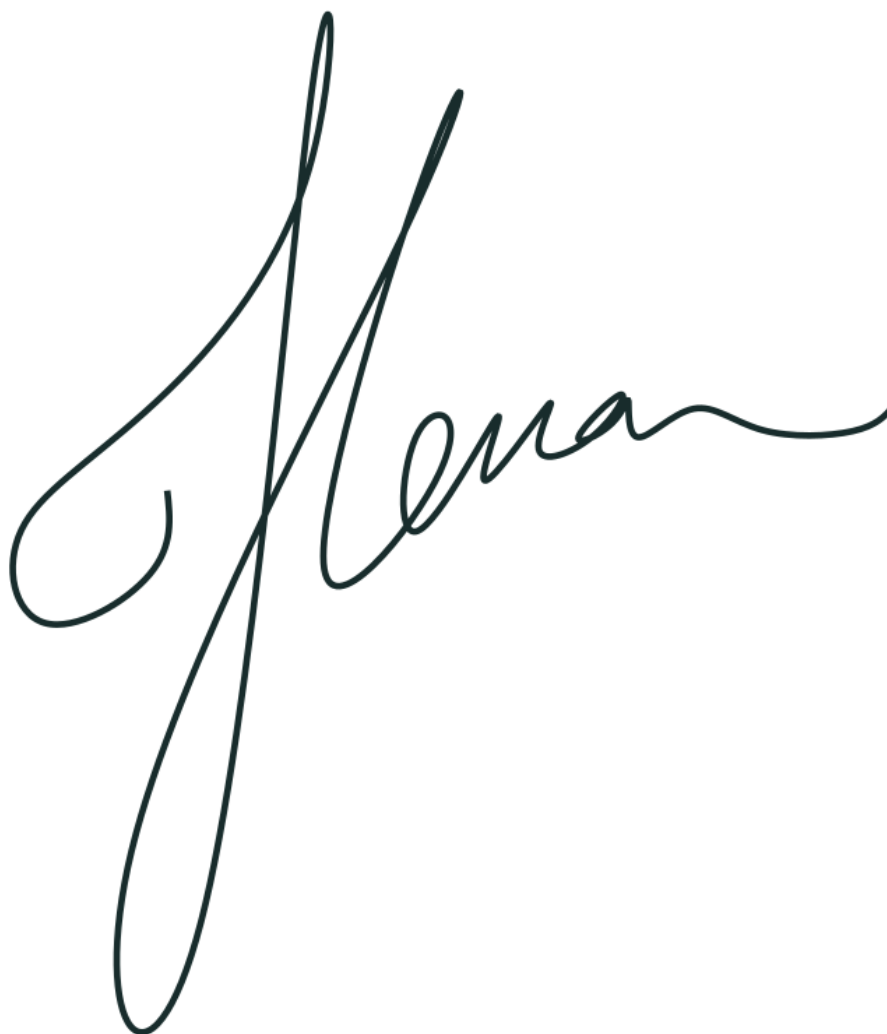
Figura 5.15: Spline cúbico de Bézier a trozos con regularidad \mathcal{C}^2 que aproxima la firma mediante el programa de diseño gráfico InkScape. Como cabría esperar, se ha obtenido el mismo ajuste que en las Figuras 5.12, 5.13 y 5.14, al emplearse para los tres casos el mismo polígono \mathbf{d}_{-1}, \dots, \mathbf{d}_{L+1} .
