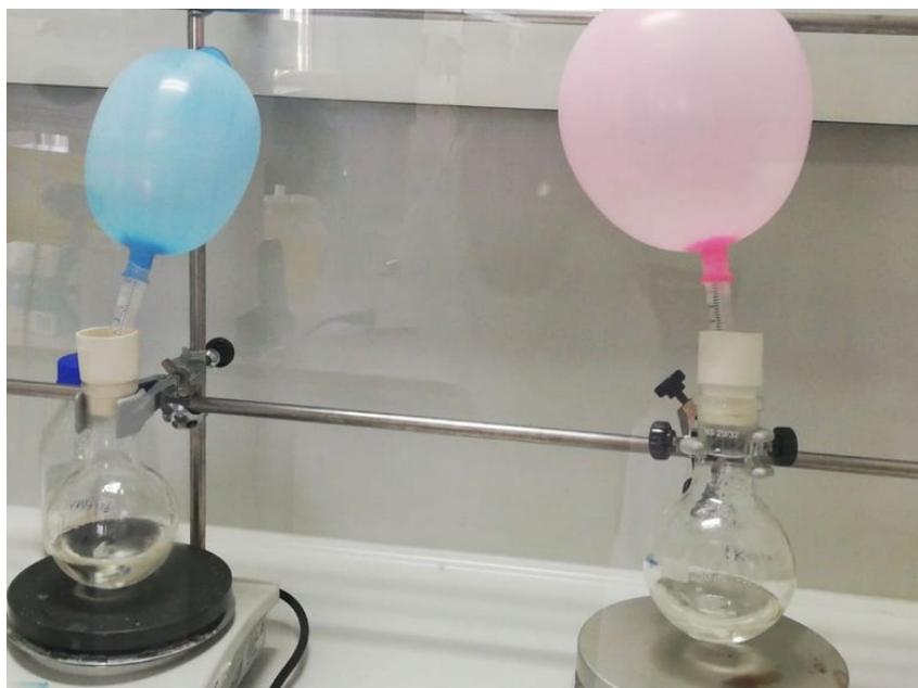
Figura 17. Uso de globos para conseguir una atmósfera inerte
