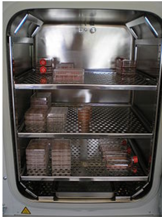
Figura 25. Interior del incubador. Dispone de una entrada de gases para crear una atmósfera rica y controlada de CO 2 .
