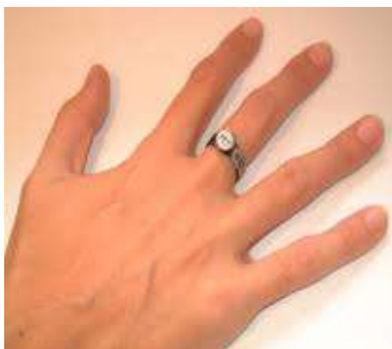
Figura 21: En la imagen superior vemos un dosímetro de solapa, en la imagen inferior izquierda un dosímetro de muñeca y en la inferior derecha un dosímetro de anillo
