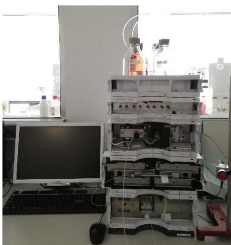
Imagen 9 Equipo de cromatografía HPLC-UV/Vis utilizado en este trabajo.
