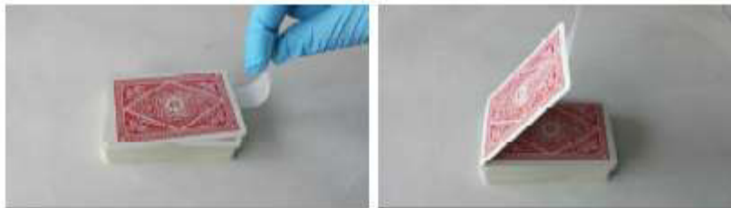
Figura 22. Simulación del método de obtención del grafeno empleando como modelo una baraja de cartas.
