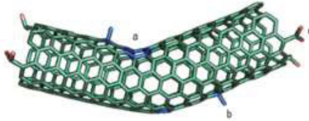
Figura 9. Esquema de la estructura de un nanotubo de carbono
