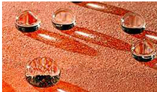
Figura 12. Comportamiento de un fluido sobre una superficie recubierta de pinturas acrílicas en las que se han añadido nanopartículas.
