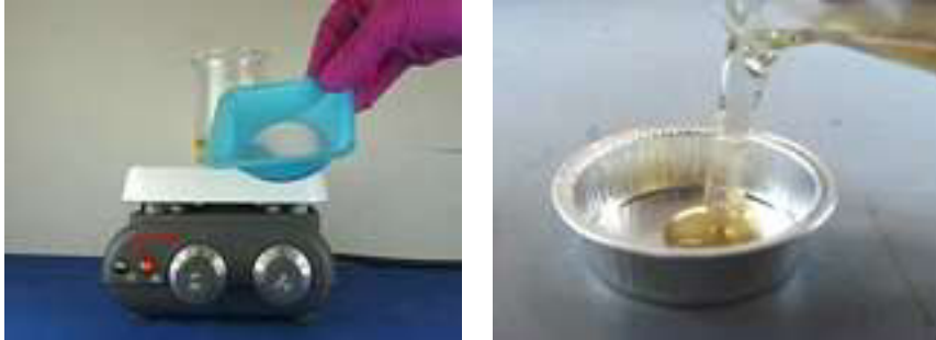
Figura 31. Pasos a seguir para fabricar las vidrieras a partir de nanopartículas de plata.
