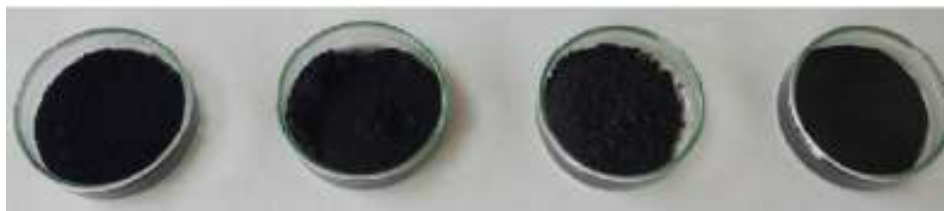
Figura 23. En orden: nanotubos de carbono, grafito, grafeno y fullerenos.
