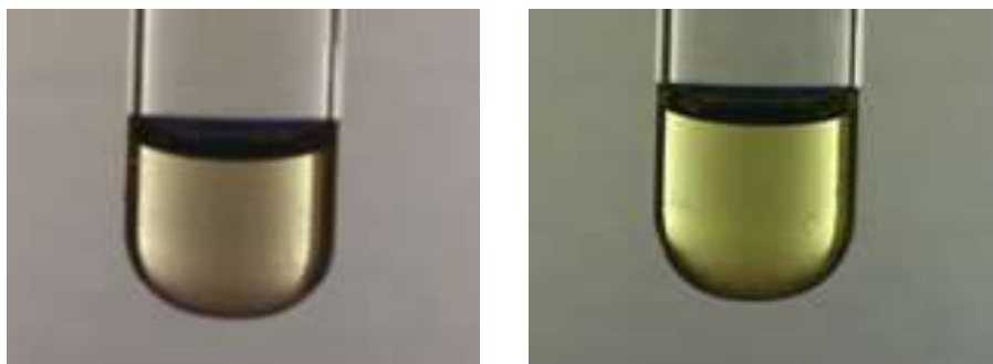
Figura 30. Cambio de coloración que demuestra la presencia de las nanopartículas de plata.
