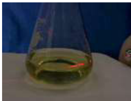
Figura 28. Reflexión de la luz del láser que demuestra la presencia de las nanopartículas.
