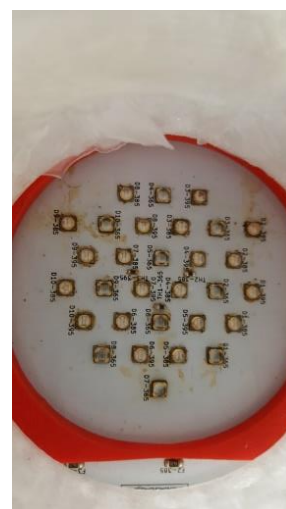
Figura 2. Lámpara UV-LED (detalle).
