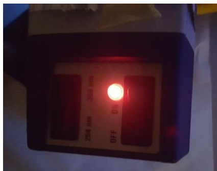
Figura 8. Detalle, lámpara de vapor de mercurio con 2 posiciones de longitud de onda: 254 nm y 366 nm.
