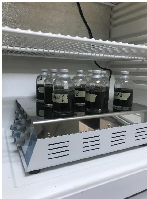
Ilustración 8: Frascos de digestión en continuo sobre agitador. Elaboración propia.
