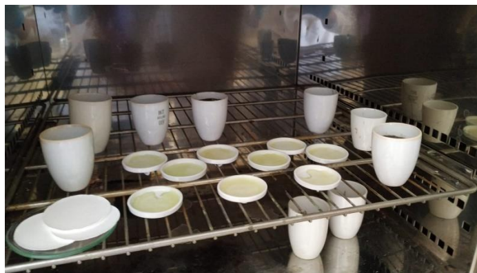
Ilustración 4: Estufa con varias muestras durante el proceso de determinación de ST. Elaboración propia
