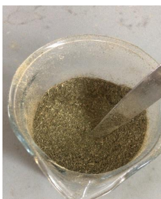
Ilustración 3: Rosa para ensayo en continuo, tras secado triturado y tamizado. Elaboración propia.
