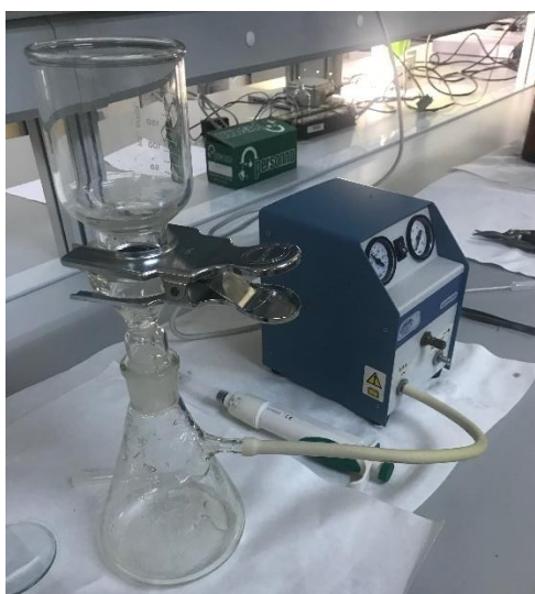
Ilustración 5: Filtro e vacío, para caracterización de inóculo. Elaboración propia.
