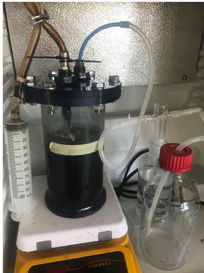
Ilustración 12: Digestor sobre placa agitadora en el interior del calentador, junto con trampa de agua y botella de recolección de agua y jeringa de alimentación. Elaboración propia.
