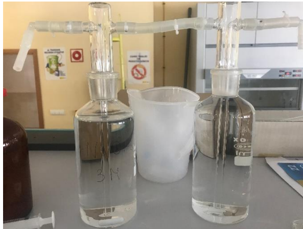
Ilustración 14: Trampa de NaOH para separación de metano. Elaboración propia
