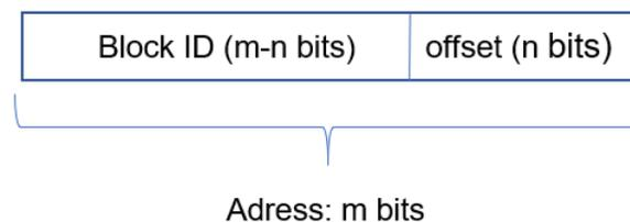
Figura 2.3: Dirección de memoria que se divide en ID de bloque y desplazamiento dentro del bloque.
