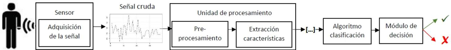
Figura 1.1: Fases involucradas en el sistema de verificación biométrica.
