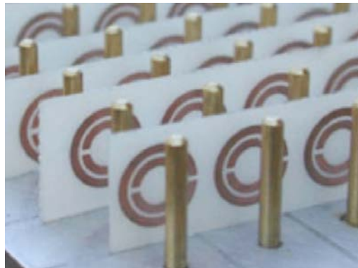
Figura 1.7 Primer metamaterial que presenta índice de refracción negativo. Los SRRs presentan permeabilidad magnética negativa \mu < 0 y los hilos permitividad eléctrica negativa \epsilon < 0 [24].
