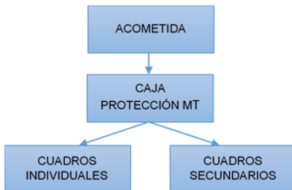
Imagen 2. Resumen esquema unifilar planteado para la fábrica de piensos.
