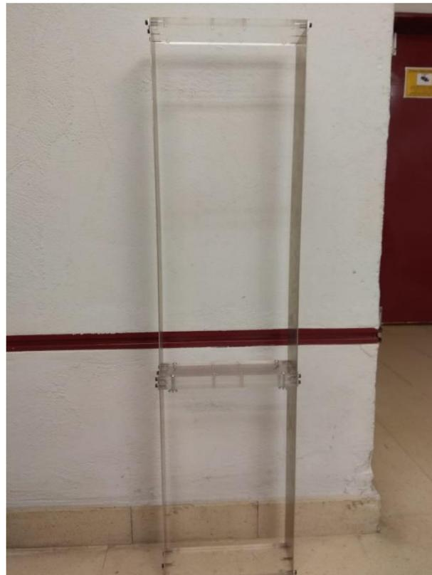
Figura 4.2. Maqueta del edificio a ensayar invertida.
