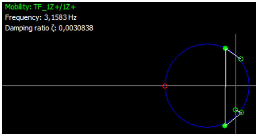
Figura 4.22. Coeficiente de amortiguamiento con el ensayo de referencia.
