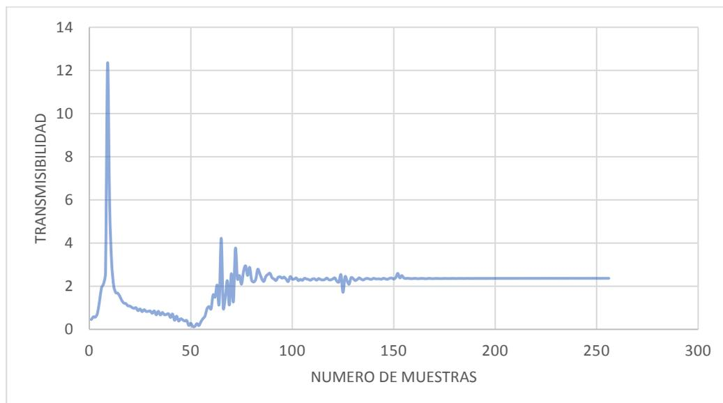
Figura 4.12.FRF en magnitud correspondiente al ensayo realizado a 200 muestras por segundo en un total de 512 muestras.
