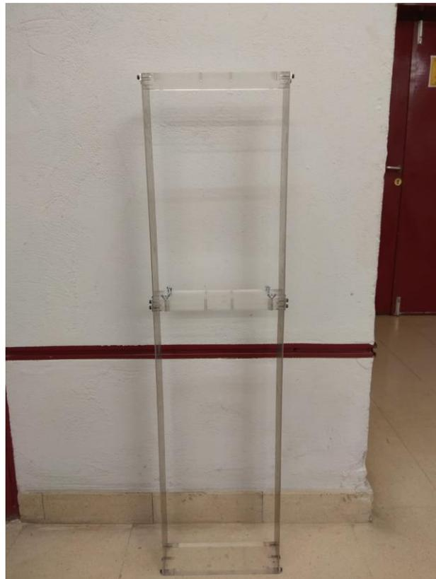
*Figura 4.1. Maqueta del edificio a ensayar*
