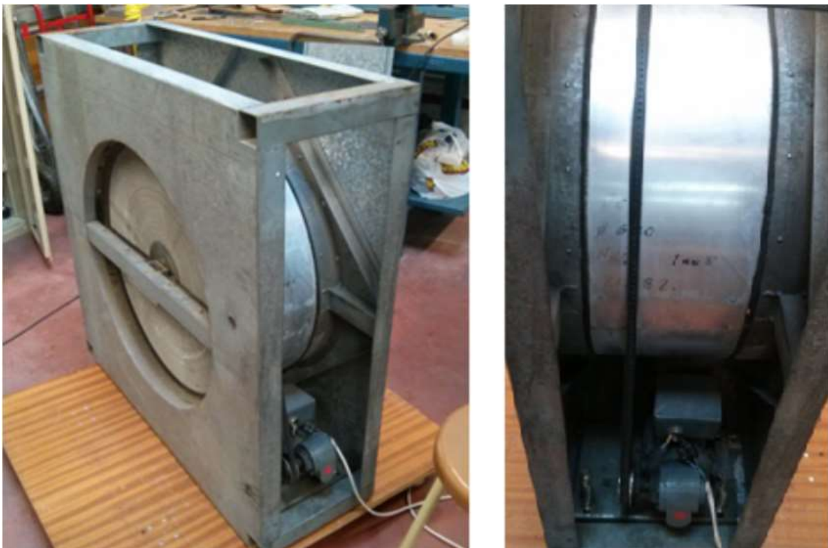
Figura 27: Recuperador rotativo empleado.
