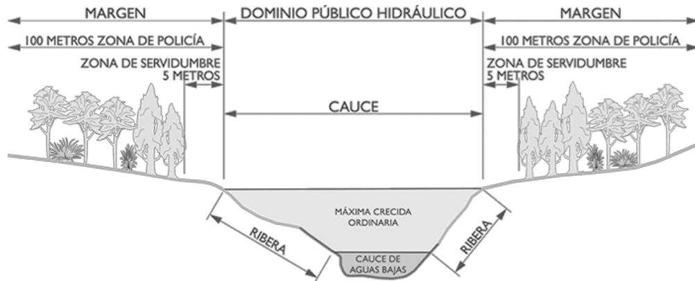
ESQUEMA DE PROTECCIÓN DE MÁRGENES DE RÍO
