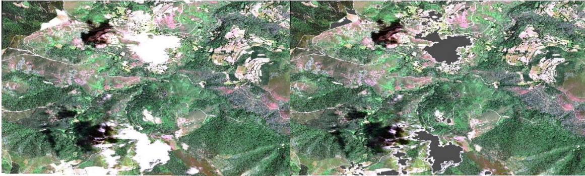
Figura 18. Imagen de Quickbird relativa a la zona norte de España. A la izquierda la imagen multiespectral, a la derecha la imagen con enmascaramiento nuboso (Digital Globe., 2020).
