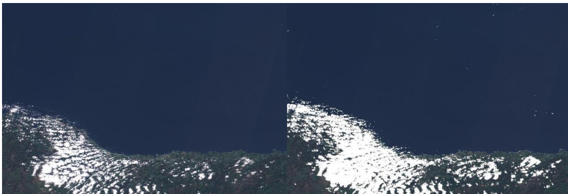
Figura 12. Comparativa de imagen 5 con su respectiva enmascarada. A la izquierda la imagen original, a la derecha la imagen obtenida mediante el algoritmo final Fmask.
