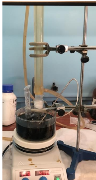
Figura 23. Destilación de los reactivos para obtener nanohilos de plata.
