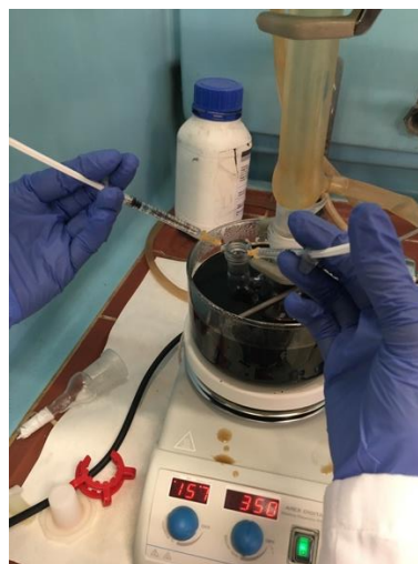
Figura 24. Adición de las disoluciones de nitrato de plata y polivinilpirrolidona gota a gota a la disolución de cloruro de cobre y etilenglicol.
