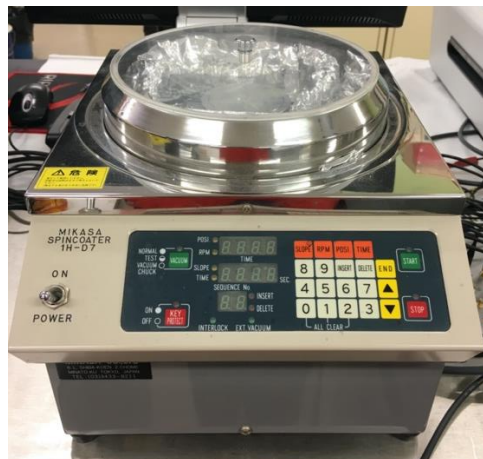
Figura 29. Spincoater utilizado para depositar los AgNWs.
