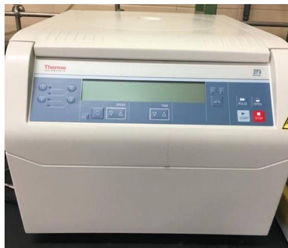
Figura 26. Centrífuga utilizada para el lavado de AgNWs.
