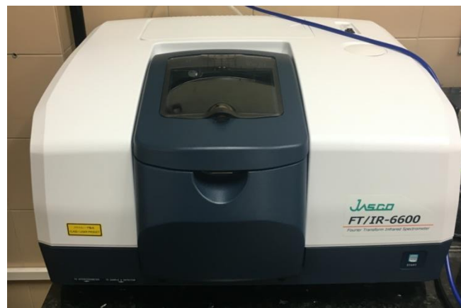
Figura 31. Espectrofotómetro FT-IR utilizado para caracterizar los sensores.
