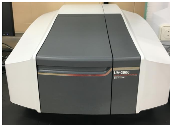
Figura 30. Espectrofotómetro UV-Vis utilizado para caracterizar los sensores.
