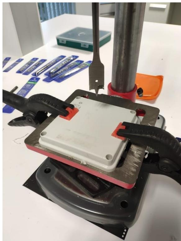
Ilustración 28. Taladrado para el módulo de ultrasonidos
