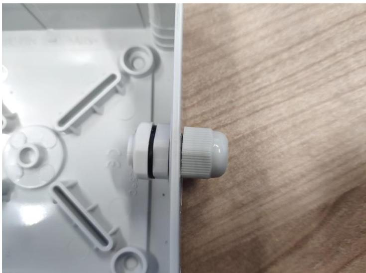
Ilustración 27. pasante para el cable del interruptor Reed
