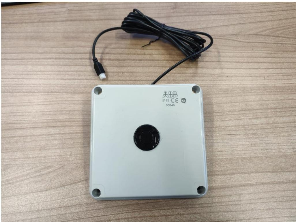
**Ilustración 29. Tapa con el módulo de ultrasonidos fijado**
