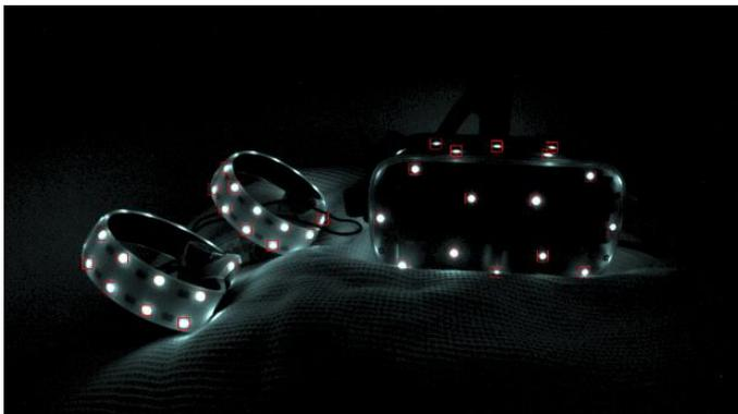
Ilustración 22: Leds en un visor Oculus y sus controladores vistos a través de una cámara infrarroja. Fuente: "cv1" de Open HMD [En línea] Disponible en <http://www.openhmd.net/index.php/blog/>
