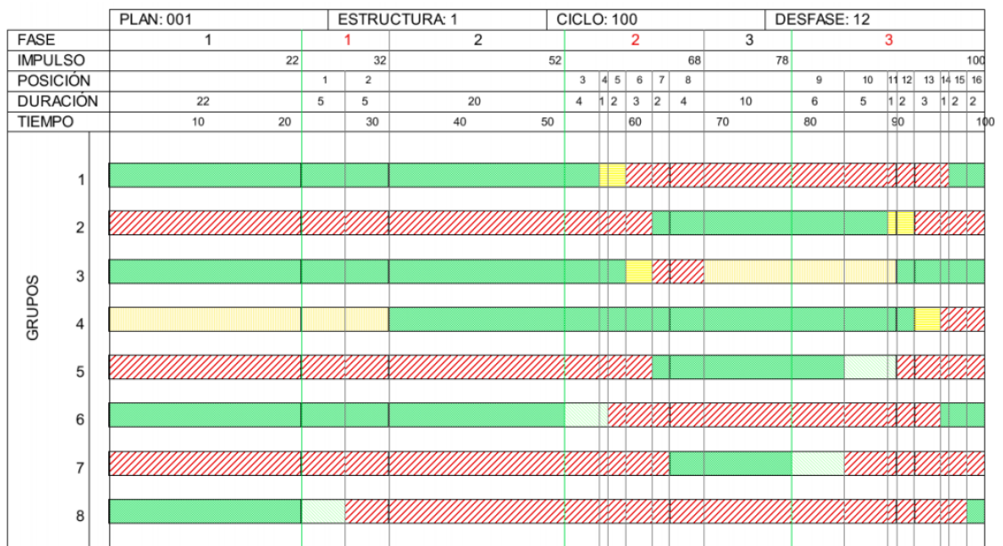
Figura A.17: Diagrama de fases del cruce 229- C/Cardenal Cisneros – C/Portillo de Balboa. Fuente: Aimsun
