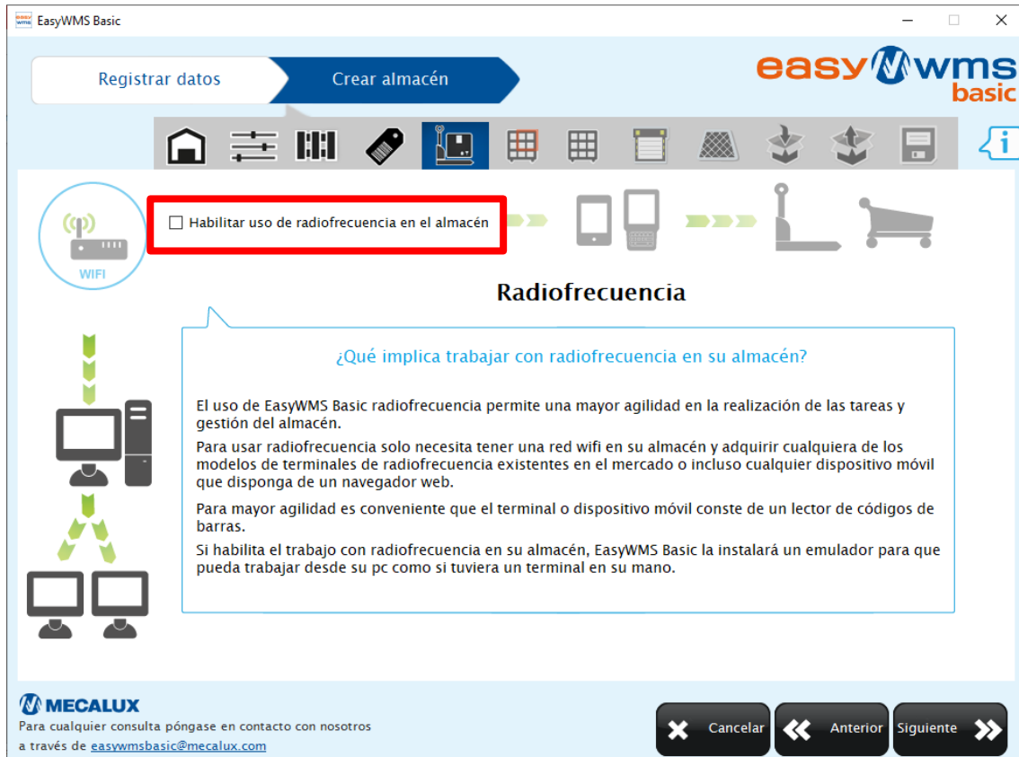
Ilustración 43: uso de terminales de radiofrecuencia deshabilitados
