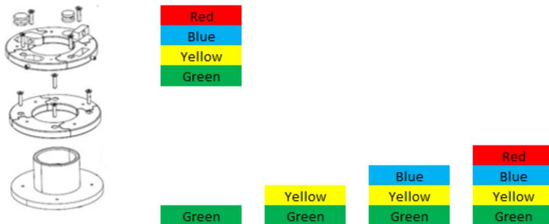
Ilustración 8: esquema de montaje del solectrón.
