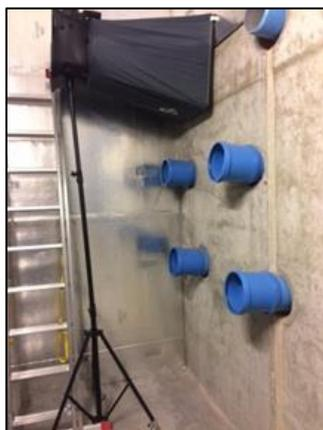
Figura 4.28. Equipo medidor de caudal (balómetro) para la caracterización del intercambiador tierra - aire [32].
