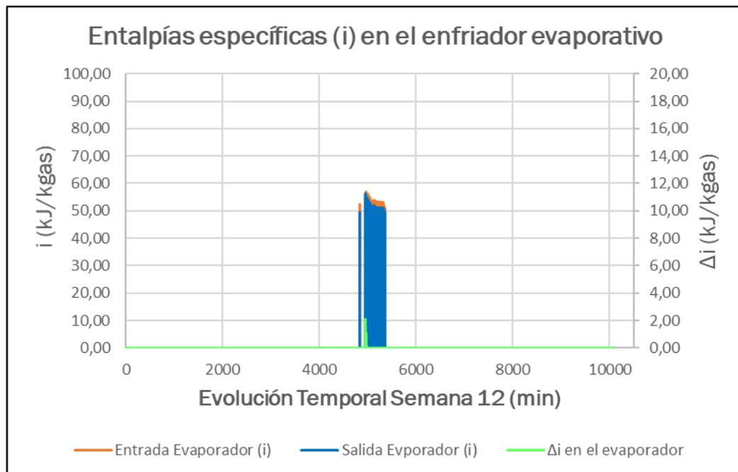
Figura A.136. Entalpías específicas a la entrada y salida del enfriador evaporativo en estacionario.
