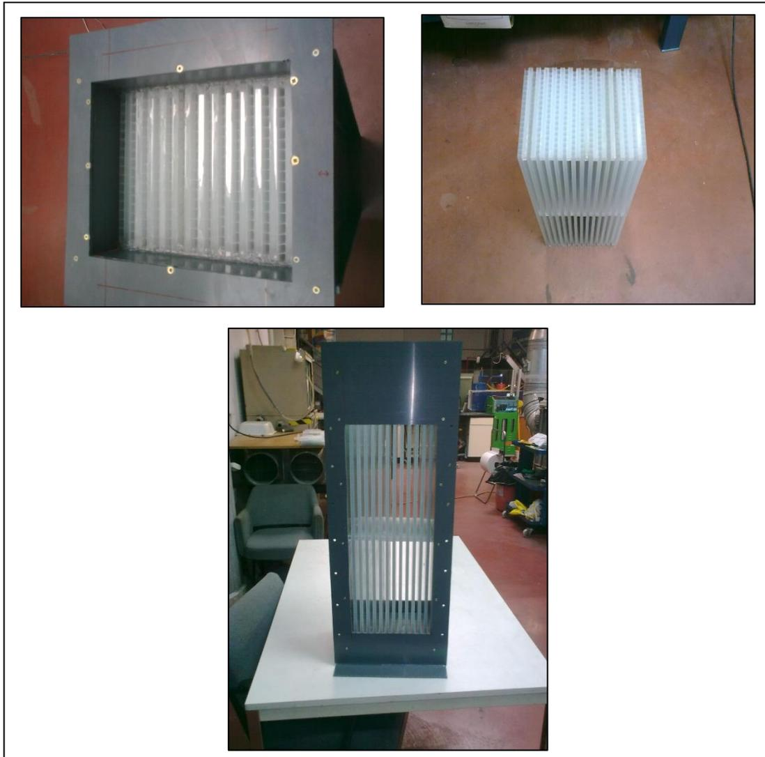
*Figura 2 2.* Elementos y fases de construcción de un evaporativo indirecto.
