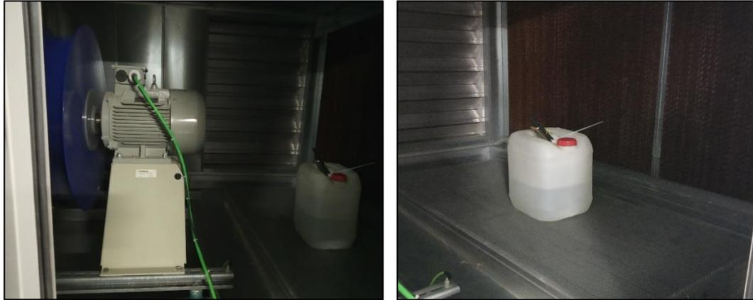
*Figura 3.13.* Monitorización de la entrada al evaporador. En la figura de la izquierda se muestran algunos de los elementos para suministro del agua al evaporador. En la de la derecha se presenta el equipo de medida (Sonda nº6)
