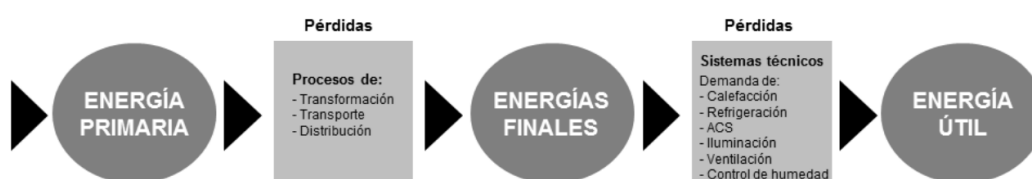
Figura 91. Esquema de tipos de energía: Primaria, Final y Útil. Fuente: CTE DB-HE0
