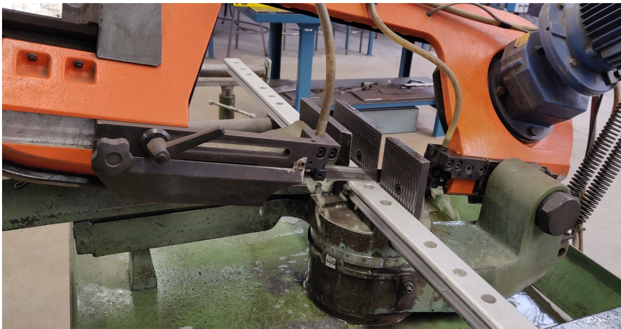
Figura 3.4: Corte del carril mediante el uso de la sierra de cinta.
