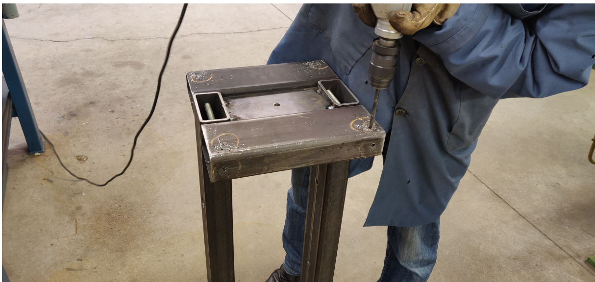
Figura 3.14: Taladrado de la base del bastidor.
