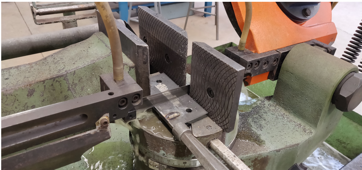
Figura 3.19: Fabricación de las placas soporte definitivas.
