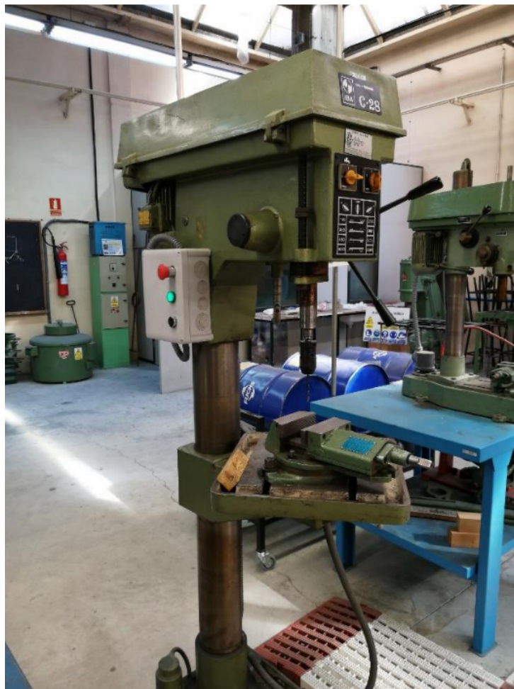
Figura 3.9: Taladro en columna de grandes dimensiones [28]
