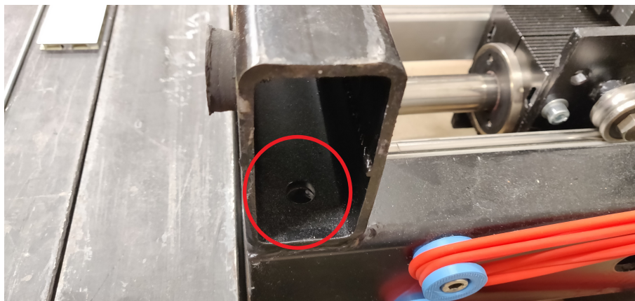
Figura 2.48: Ubicación de los espárragos provisionales M12.
