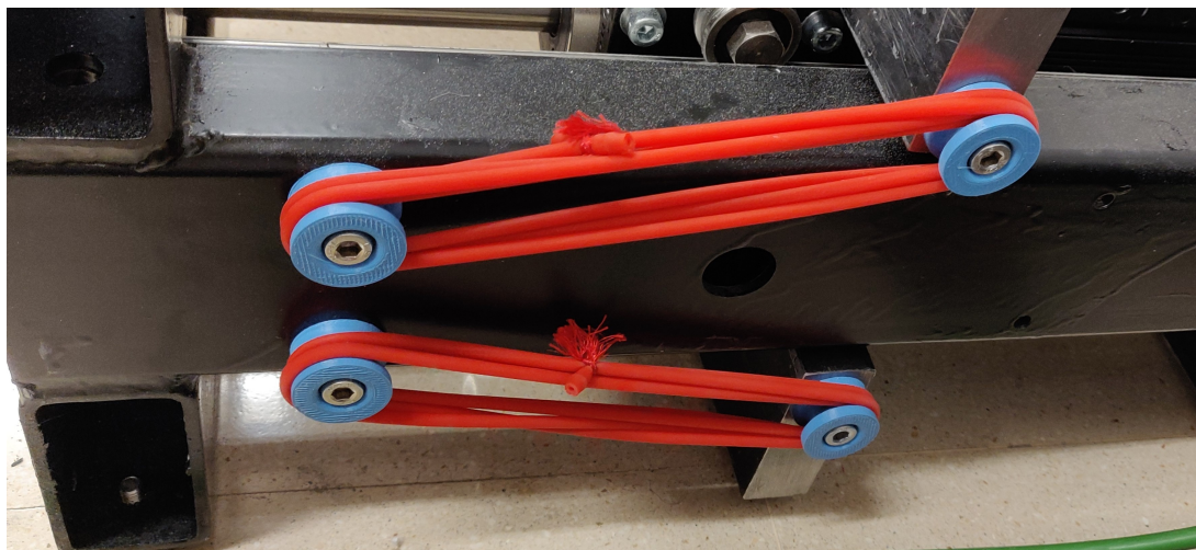
Figura 3.35: Sistema de suspensión instalado para el modo corriente.
