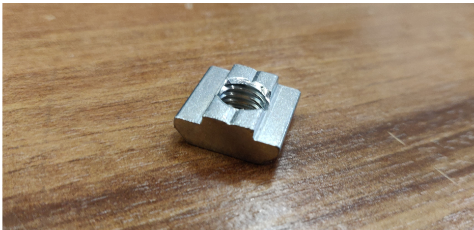
Figura 2.28: Tuerca de martillo deslizante.
