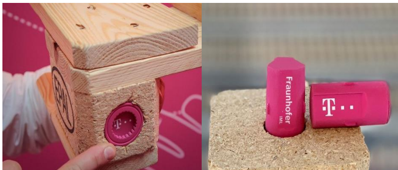
Figura 5: Solución que presenta Deutsche Telekom para la localización de palés. (7)
