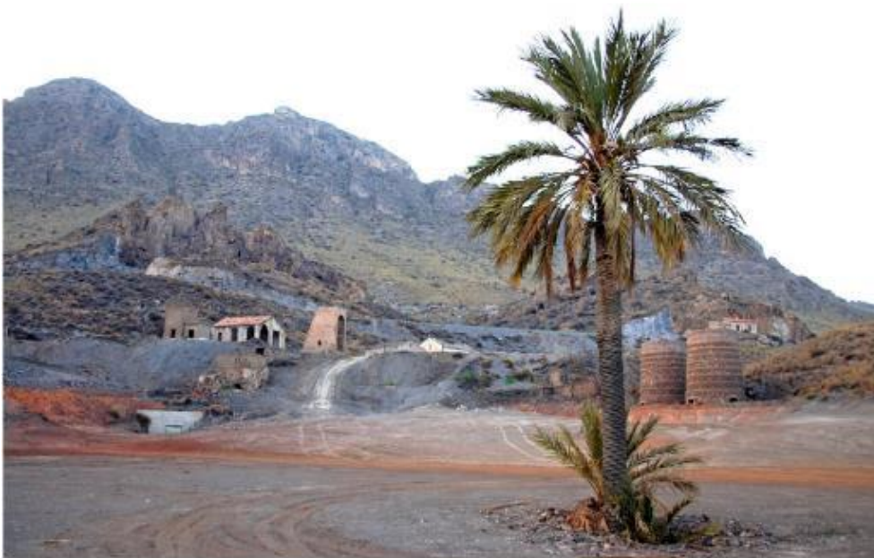
Figura 29. Vista general de las instalaciones, hornos de fundición y el castillete de mampostería. "Reproducida de Archivo Histórico Minero. Autor: Gumersindo Fernández García".
