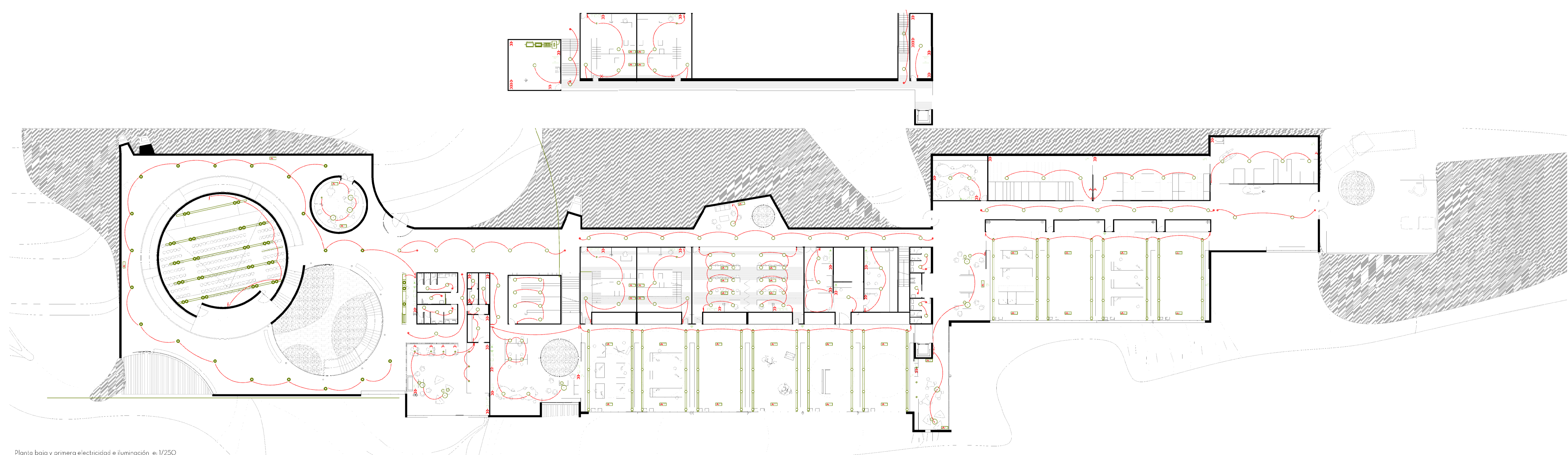
Planta baja y primera electricidad e iluminación e: 1/250
