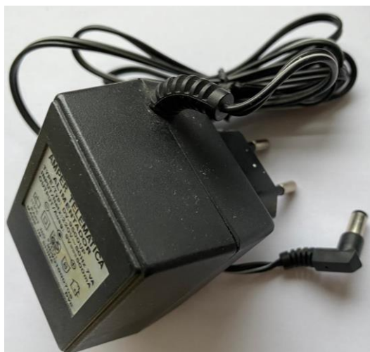
ILUSTRACIÓN 11: FUENTE DE ALIMENTACIÓN REUTILIZADA 9V – 700MA
