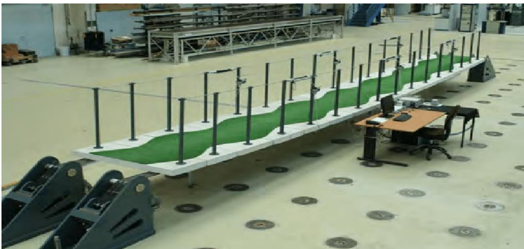
Figura 1.5 Prototipo de pasarela de fibra de carbono TU Berlin [6]
