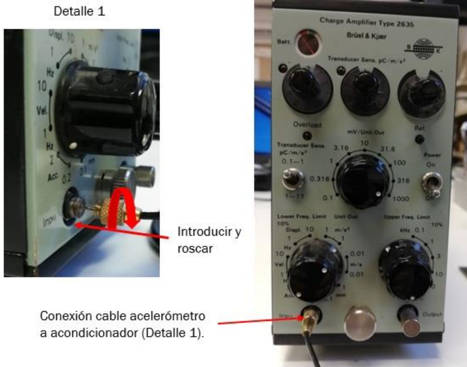
Figura A.5 conexión del acelerómetro al acondicionador.
