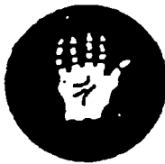
RIESGO DE CORROSION
