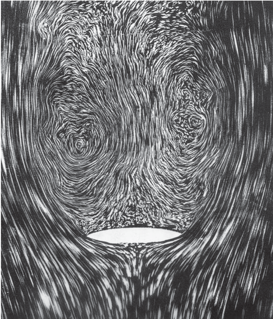
Fig. 11 J. Hunsaker, MIT "Flow of fluid passing an obstacle". J. Hunsaker, MIT "Flujo de un fluido pasando un obstáculo".
