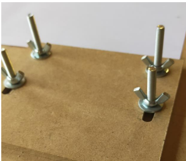
Figura 52. Implementación de la primera mejora del puesto 2: mariposas de agarre. Fuente: elaboración propia
